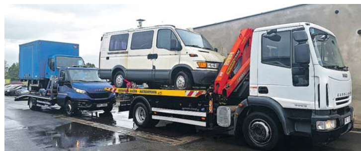
Kontejnerový nosič a odtahový speciál na svoz autovraků
